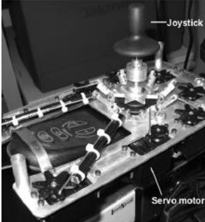
El proyecto IATSL-IWs del Instituto te Rehabilitación de Toronto se enfoca al control de una silla de ruedas en adultos con dificultades cognitivas. El sistema emplea una EPW modificada para poder ser controlada por el joystick háptico como lo muestra la Figura 3. Adicionalmente el sistema da una retroalimentación al usuario de forma auditiva.
