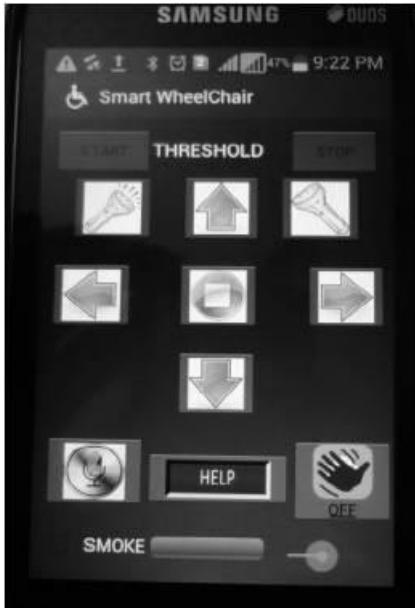
El proyecto PUNE-IWs del colegio de ingeniería e investigación de Dnyanganga en India consiste una silla de ruedas inteligente con sensores de obstáculos, temperatura, gas y vinculación con un teléfono inteligente a través de Bluetooth para lograr un poco de movimiento independiente.
