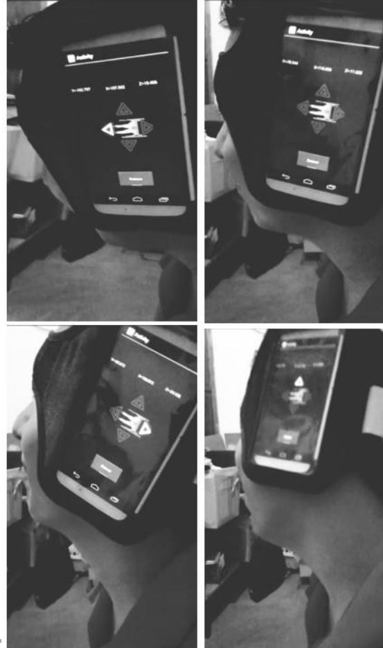
Se probó la aplicación en diversos Smartphone obteniendo una frecuencia en el ciclo de detección y control que varía entre 8.3 y 7.6 veces por segundo, debido a que los motores requieren un tiempo de arrancado y variación de velocidad además que el cambio de dirección propuesta no es constante el periodo obtenido es aceptable.
